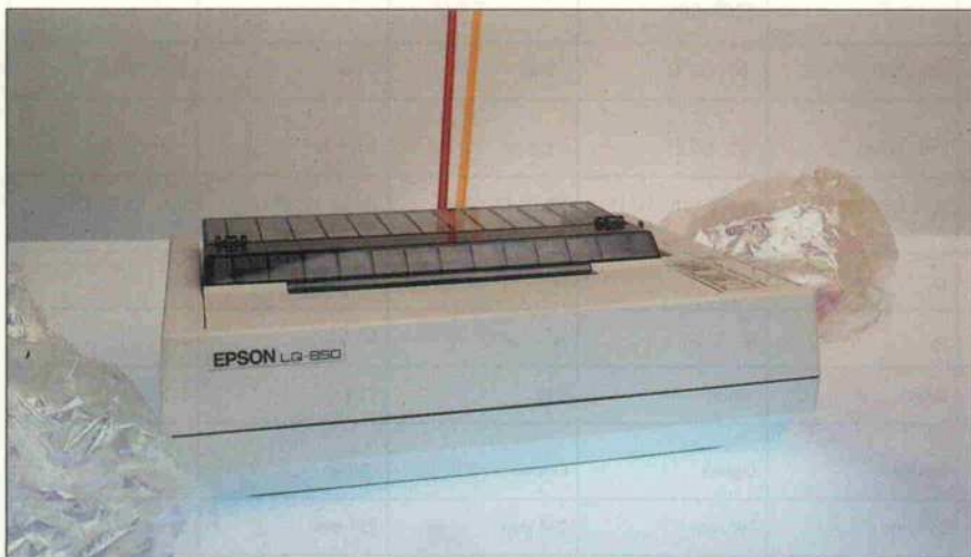
Ein übersichtliches Bedienfeld mit großen Kurzhubtasten zeichnet den Epson LQ-850 aus. Für diesen Drucker steht eine Vielzahl von Zubehör zur Verfügung: Schriftkassetten, Emulationskassetten (IBM/Qume), serielle Schnittstelle, Einzelblatteinzug.
