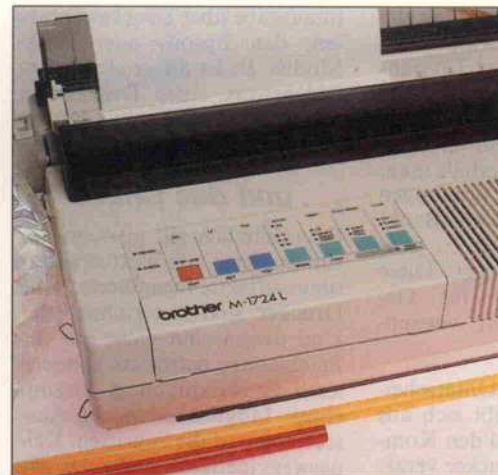
Eine leichtgängige Folientastatur, die auch durch die farbliche Kennzeichnung leicht bedienbar ist. Unter der Klappe mit der Firmenbezeichnung verbirgt sich der Modulschacht des Brother M-1724L.
