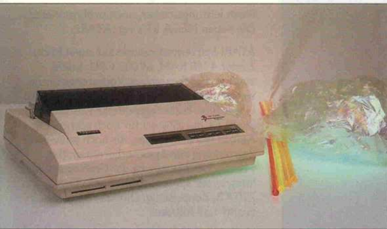
'Klartextdialog' beim Toshiba P-321: Mit der LC-Anzeige wird auch die Menü-einstellung durchgeführt. Durch die eindeutige Tastenbeschriftung ist dazu nicht einmal ein Handbuch nötig.
