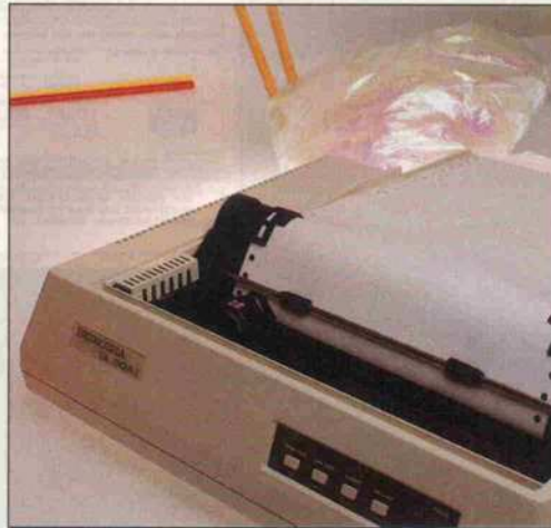
Der Zugtraktor des Seikosha SL-80AI ist abnehmbar. Bei Traktorbetrieb ist durch den aufgesetzten Traktor Blattverlust bei Manuskriptende unvermeidlich.
